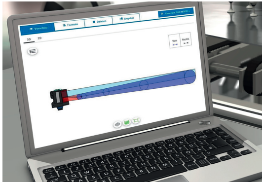
图4：光束路径被整合到三维CAD数据中。这简化了从设计到安装的路径，因为传感器可以完全按照设计安装，而不需要微调。
