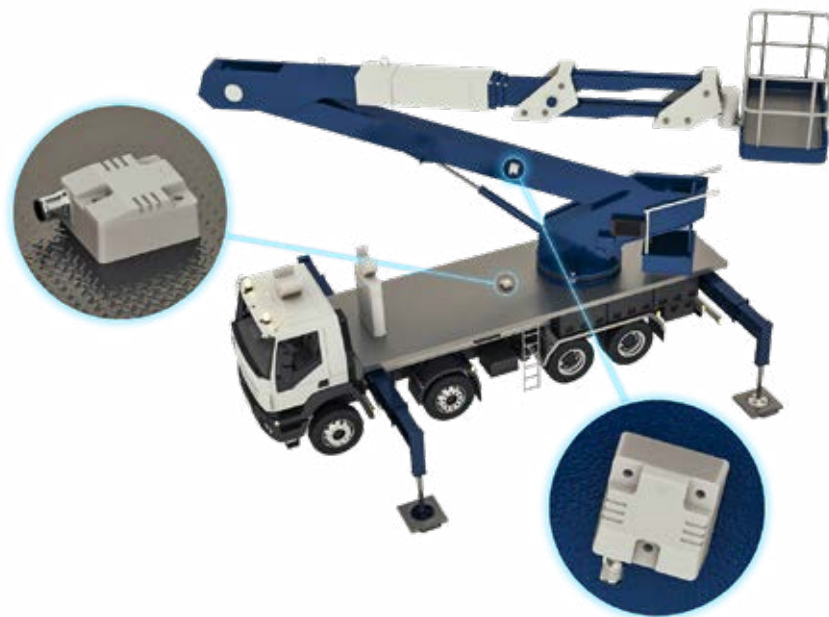
GIM500R: Controllo planarità del veicolo ed angolazione del braccio
